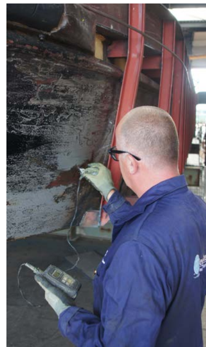
Tot de veiligheidskeuring behoort ook het meten van de dikte. Bij gebruik van speciaal materiaal, zoals Hardox, mag worden afgeweken van de minimumdikte van drie millimeter, mits de sterkte dan gegarandeerd is.
